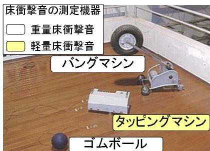
スラブの床衝撃音遮断性能はJISで規定された基準衝撃源を用いて評価されている
